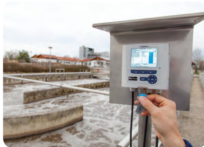
System 282/284 z interfejsem USB i pamięcią danych w standardzie
