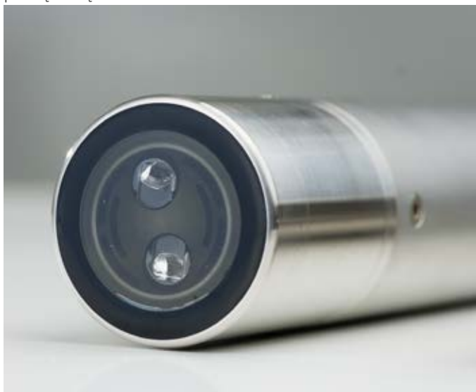
Optyczne okna pomiarowe i dysk szafirowy z systemem czyszczenia ultradźwiękami
