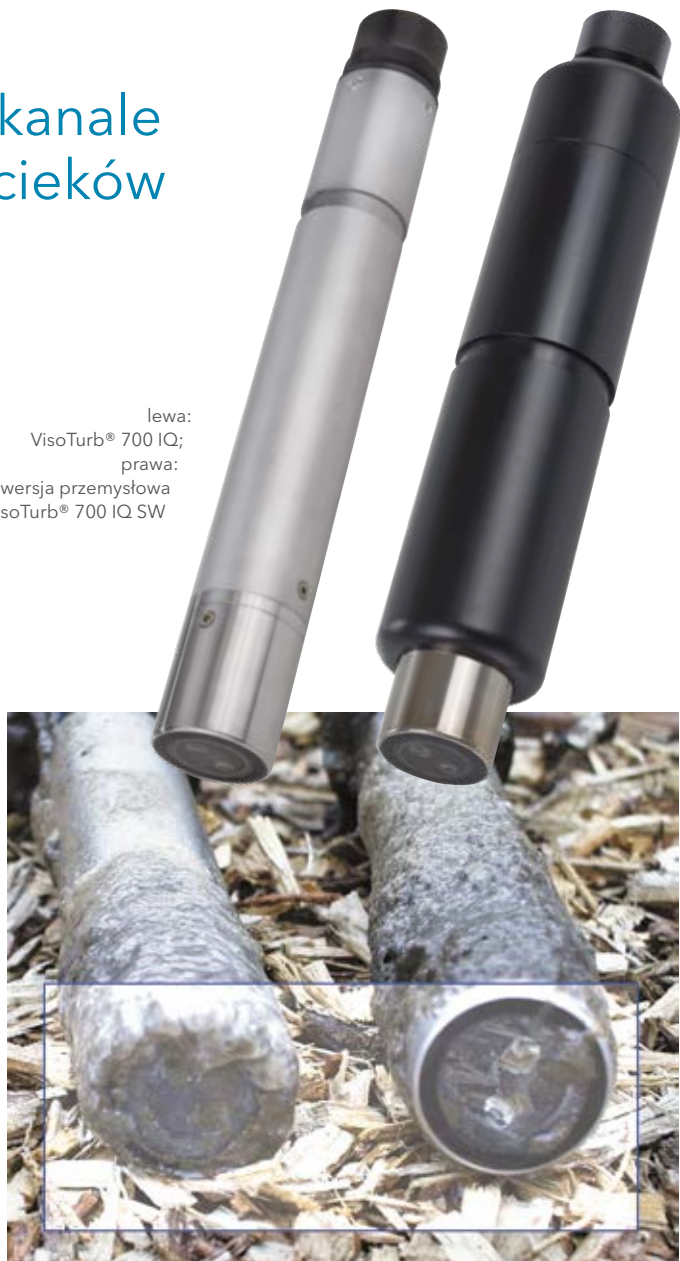
Sonda bez i z systemem czyszczenia ultradźwiękami po 30 dniach
