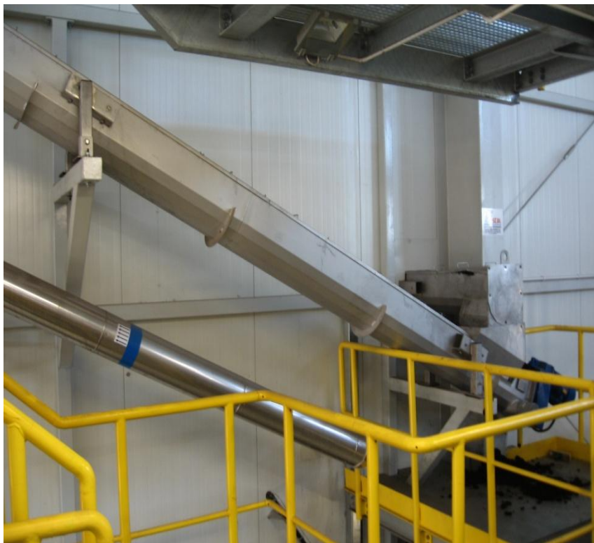
Przenośniki osadu odwodnionego z SMOO do ITPO
