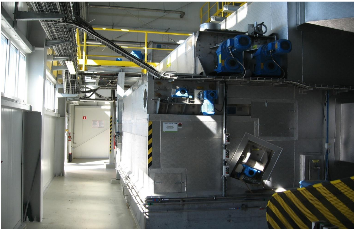
Moduł załadowniczy suszarni osadu
