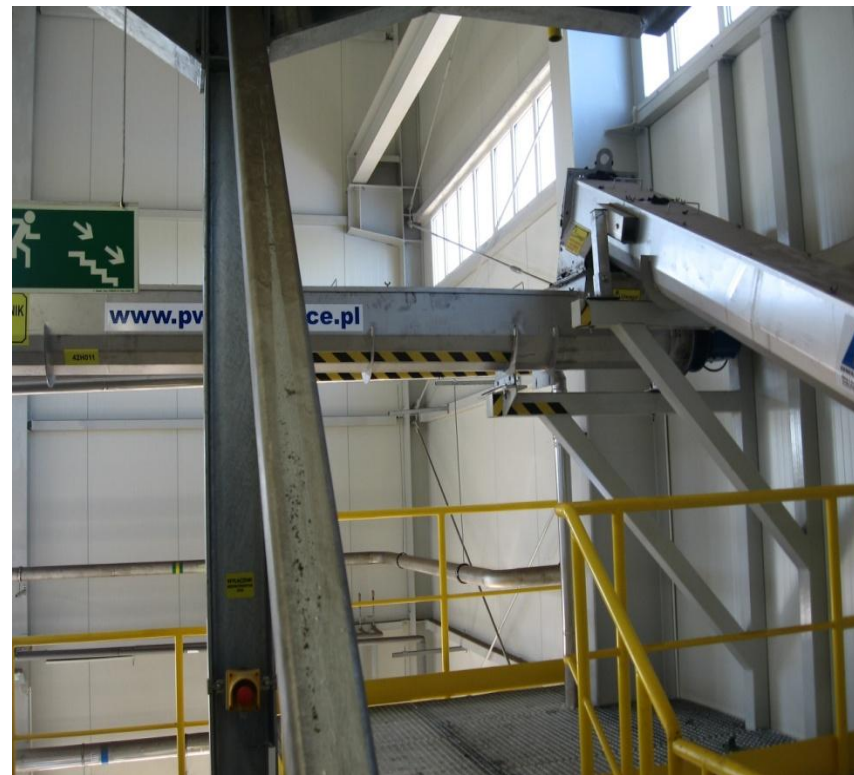
Przenośniki osadu odwodnionego z SMOO do ITPO
