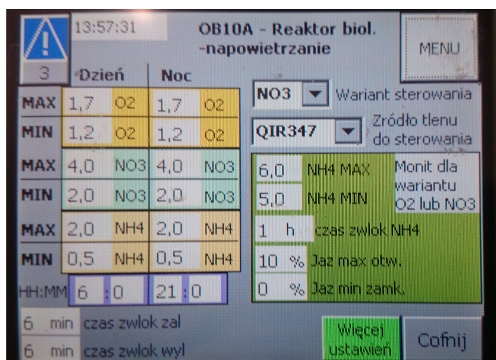
Rys. nr 5. Przykładowe parametry procesu w reaktorach biologicznych.
