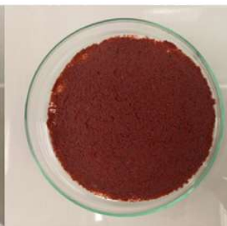
Odseparowane i zawrócone do reaktora granulki deamonifikujące
