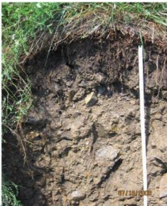
Profil gleby technogennej wytworzonej ze skały płonnej – Virginia USA 19 lat po rekultywacji zastosowaniem osadów ściekowych
