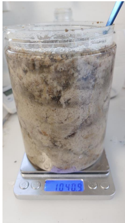
Skratki przed płuczką (surowe) zalane wodą – po dodaniu koagulanta
