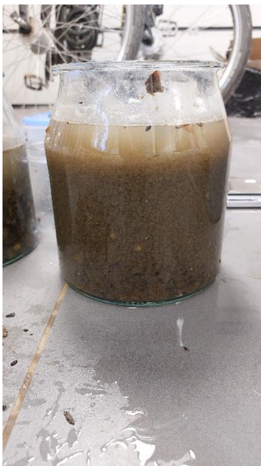
Różne fazy sedymentacji cieczy popłucznej (po lewej po 2 minutach sedymentacji, po prawej po 10 minutach sedymentacji) – 16-04-2024
