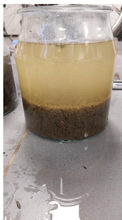
Różne fazy sedymentacji cieczy popłucznej (po lewej po 2 minutach sedymentacji, po prawej po 10 minutach sedymentacji) – 16-04-2024
