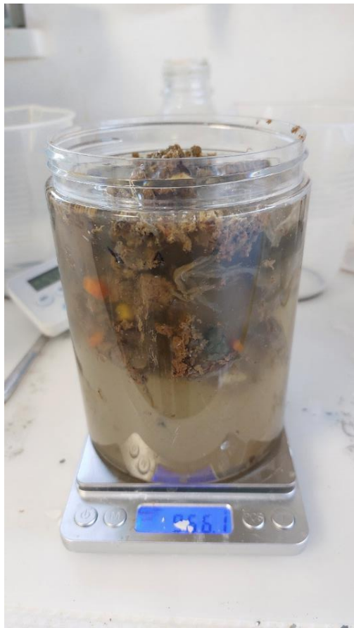
Skratki przed płuczką (surowe) zalane wodą
