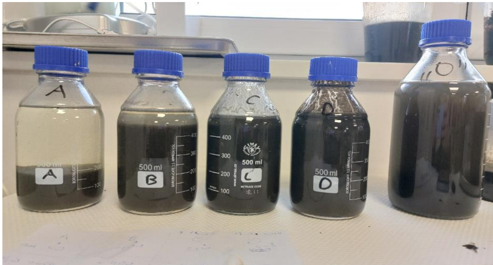
Osady przefermentowane w różnym rozcieńczeniu poddane działaniu koagulanta
