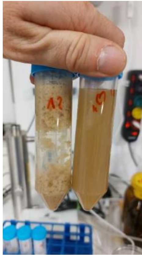
Próbki ścieków stężonych oraz oczyszczonych w kolejnych fazach
