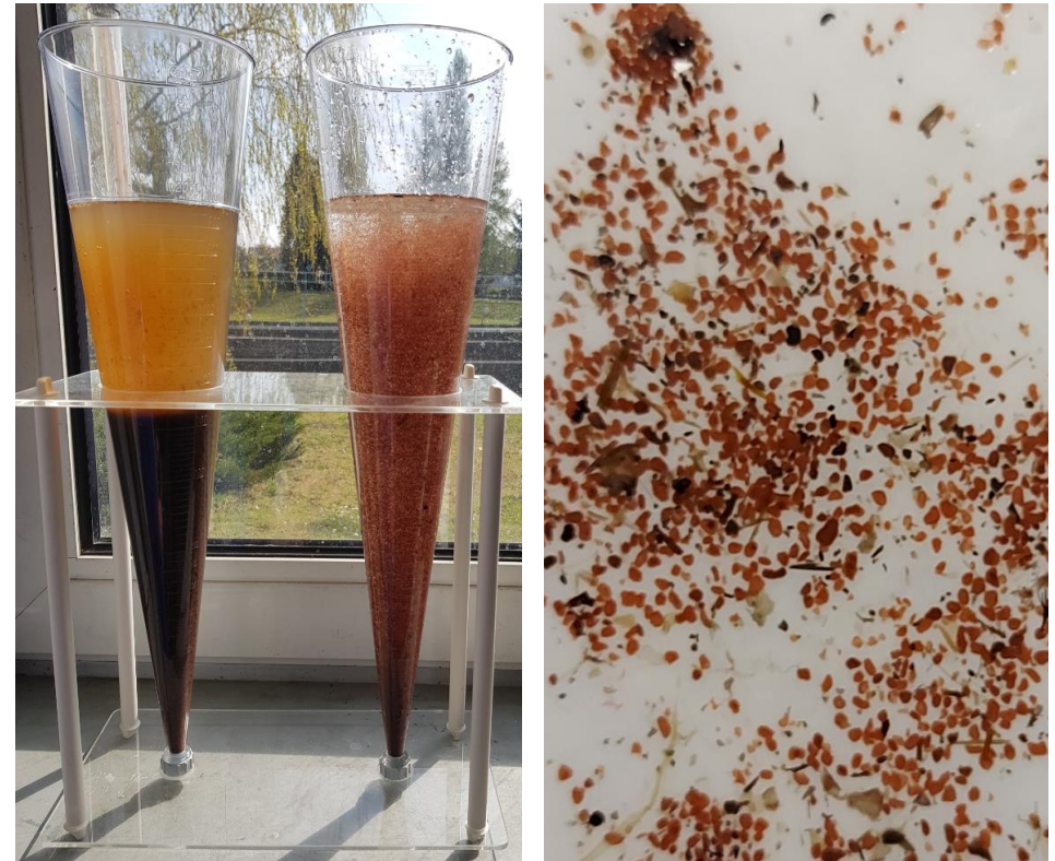
Test Opadalności osadu czynnego i AMX (po lewej) oraz odseparowane AMX (po prawej)
