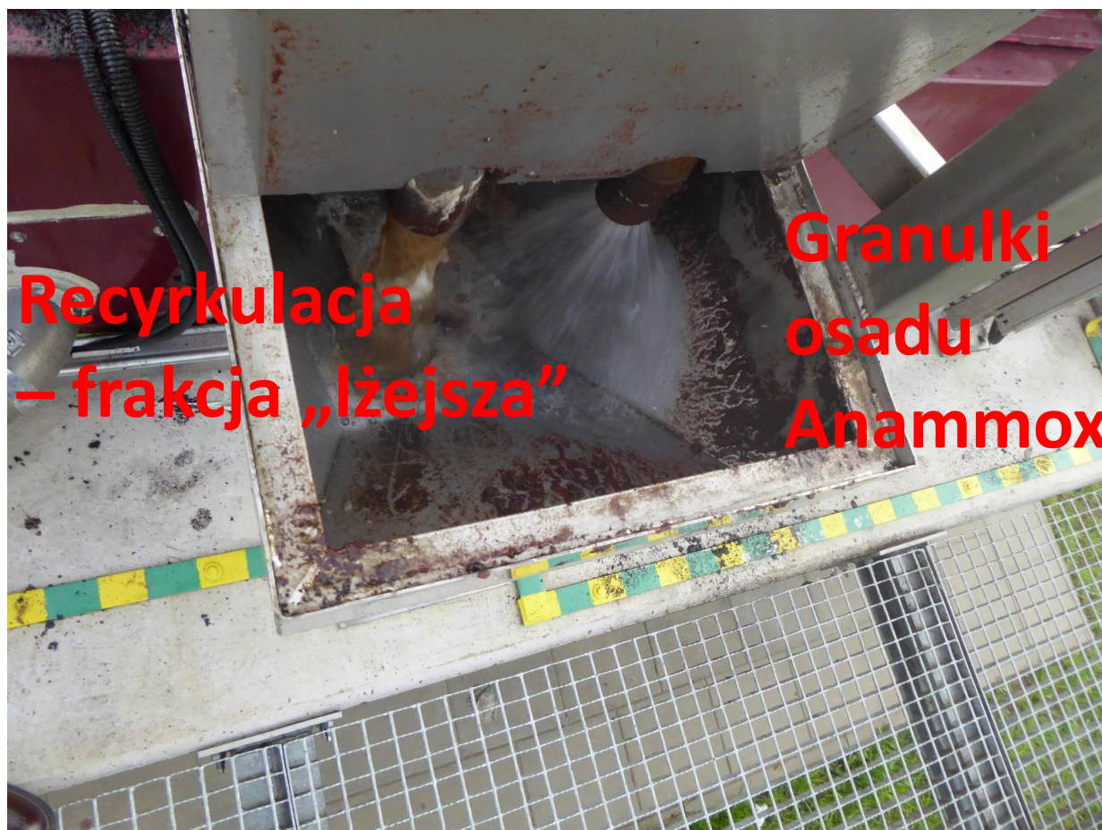
Rys.4. Separacja bakterii anammox w hydrocyklonie.
